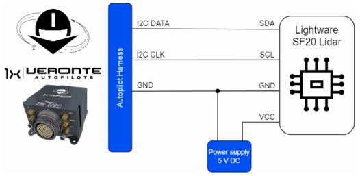
**Lightware SF20 Lidar - Autopilot 1x wiring diagram**
