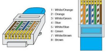
RJ45 pinout T-568B
