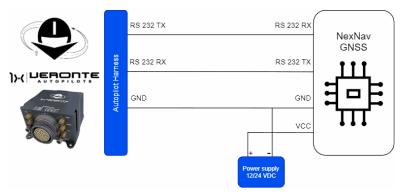
NexNav GNSS - Autopilot 1x wiring diagram
