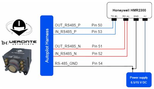
Magnetometer Honeywell HMR2300 (RS485) - Autopilot 1x wiring diagram
