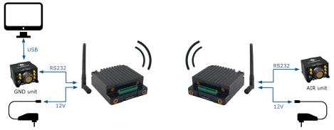
**DTC radios and Autopilot 1x operation**
