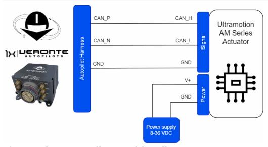
Ultra Motion - Autopilot 1x wiring diagram
