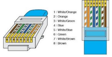
RJ45 pinout T-568B
