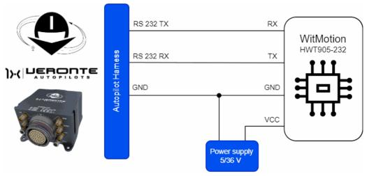
WitMotion HWT905-232 - Autopilot 1x wiring diagram
