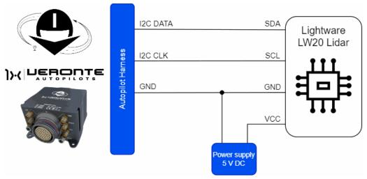
**Lightware LW20 Lidar - Autopilot 1x wiring diagram**
