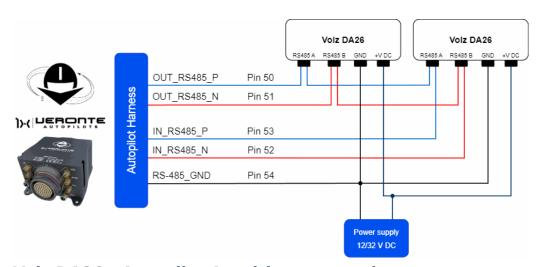
**Volz DA26 - Autopilot 1x wiring connection**
