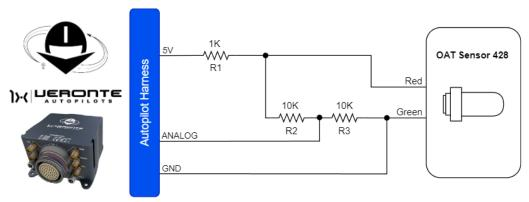
**OAT** sensor - Autopilot 1x wiring diagram
