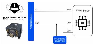
PWM - Autopilot 1x wiring diagram
