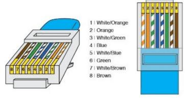
RJ45 pinout T-568B
